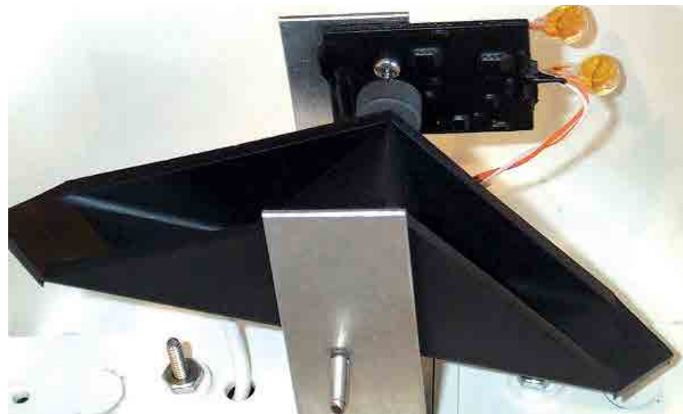
Figura 104 - Funcionamento interno de um pluviômetro
